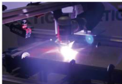
하나의 용접 비드 작업 (single pass welding) 직선 주행 용접 (line welding)
