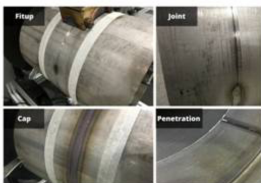
온라인 작업 (on-line Demonstration) 서스 파이프 용접 가공
